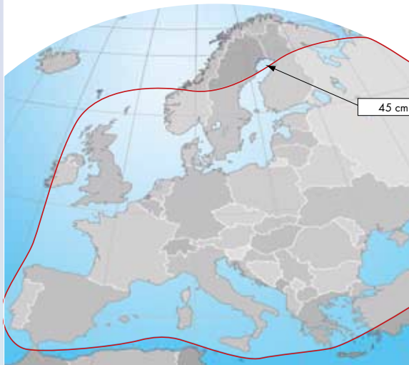
Ausleuchtzone Eutelsat Eurobird 9° Ost Frequenzbereich 11,727 - 12,092 GHz
