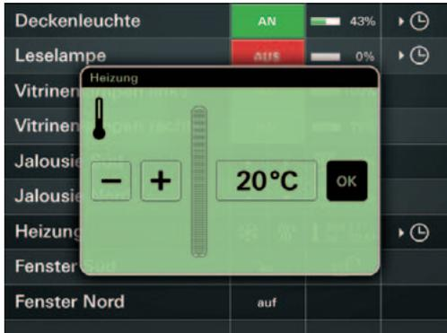
Die Temperatur kann für jeden Raum komfortabel und individuell geregelt werden. Über Tür- und Fensterkontakte registriert das System, wenn eine Tür oder ein Fenster geöffnet wird und fährt die Heizung herunter.
