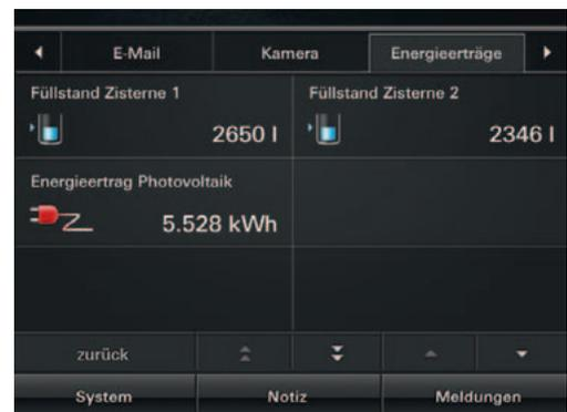
Über das Gira Interface lässt sich der Wasserstand einer Zisterne oder der Energieertrag einer Photovoltaikanlage einsehen.
