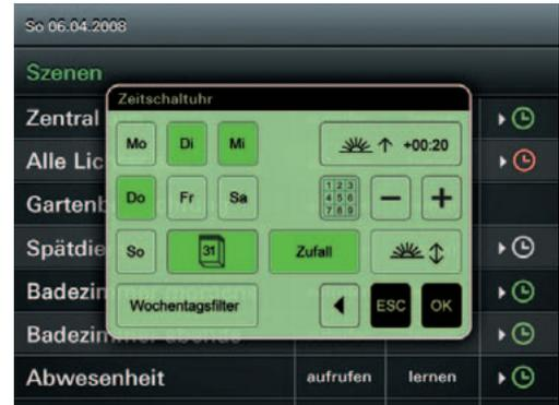
Für jeden einzelnen Raum lässt sich ein eigenes Nutzerprofil mit den Zeiten erstellen, in denen der Raum geheizt oder gelüftet werden soll. So sind Heizung und Lüftung nie unnötig in Betrieb.
